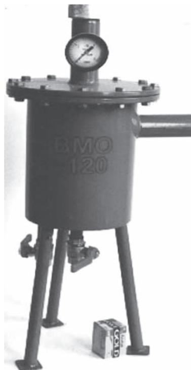
Рисунок 6 — Фильтр-влагомаслоотделитель для пневмосистем. Производительность: 60; 120; 300; 1200 м<sup>3</sup>/ч. Точка росы не выше  $-5^\circ C$
