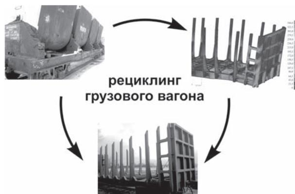
Рисунок 1 — Исходный и перепрофилированный вагоны
