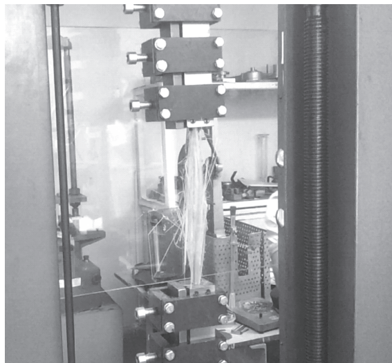
Рисунок 2 — Разрушение композитной арматуры
