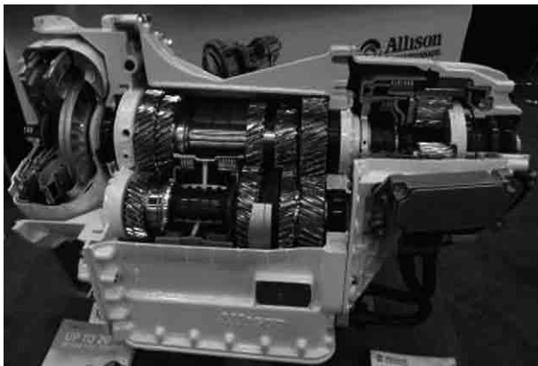
Рисунок 12 — ГМП TC10 компании Allison Transmission
