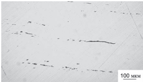
Рисунок 2 — Микроструктура продольного образца № 1 из стали 25XГНМ (плавка 64541): a — травление по патенту [7]; б — без травления
