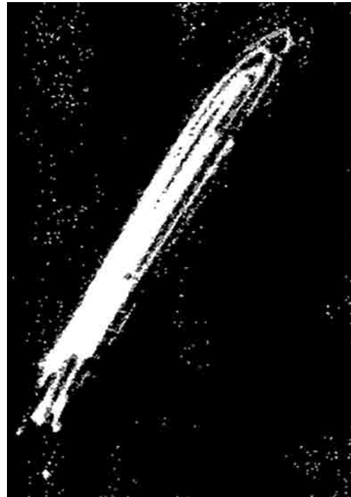
Рисунок 7 — Траектория движения центра вала в подшипнике с зазором [11] Figure 7 — Trajectory of shaft center movement in bearing with clearance [11]
