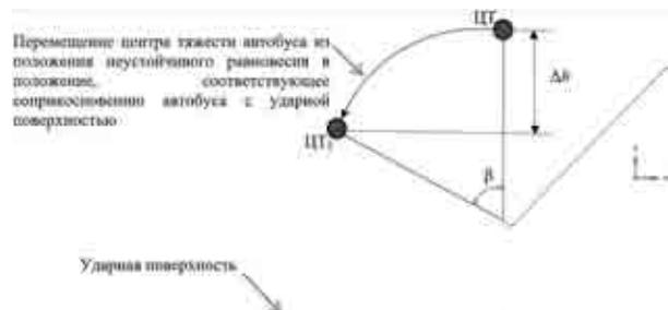
Рисунок 3 — Расчетная схема для определения перемещения центра тяжести автобуса
