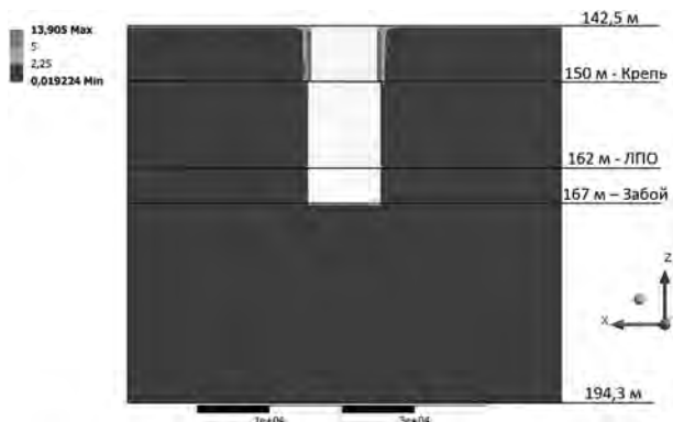
Рисунок 4 — Оценка прочности вмещающего массива по критерию (3)
