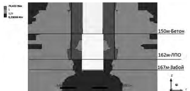
Рисунок 2 — Оценка прочности вмещающего массива по критерию (1)
