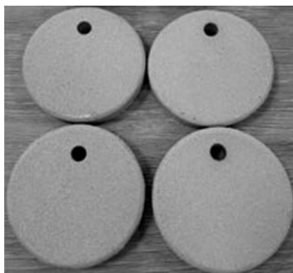
Рисунок 1 — Образцы полиамида ПА-6 с нанесенным алюминиевым покрытием Figure 1 — Samples of polyamide PA-6 with aluminum coating
