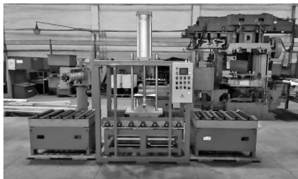
Рисунок 11 — Комплекс для изготовления стержневых пакетов, получаемых из песчано-смоляных смесей Figure 11 — Complex for production of core assemblies, produced from sand and resin mixtures
