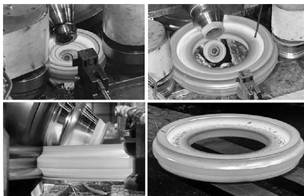
Рисунок 24 — Возможности кольцераскатки: a — номенклатура деталей для кольцераскатки; b — раскатка профильных колец Figure 24 — Ring rolling capabilities: a — nomenclature of parts for ring rolling; b — rolling of profile rings
