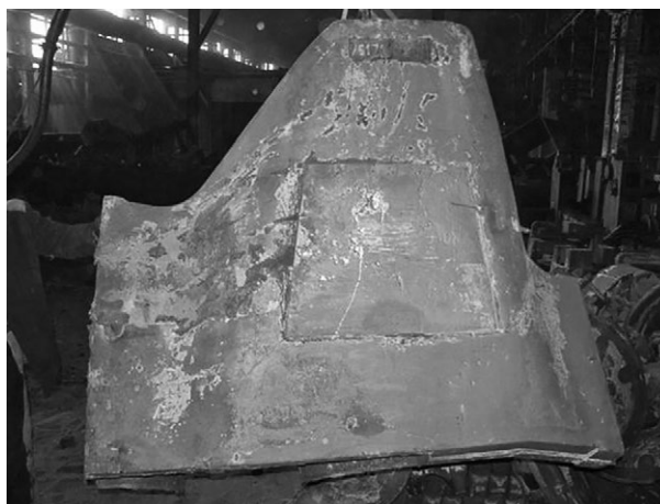
Рисунок 3 — Общий вид опоры поперечины рамы карьерного самосвала БЕЛАЗ (a) и ее отливки из стали 15НМФЛ (b) Figure 3 — General view of BELAZ dump truck frame crossbeam support (a) and its casting made of steel 15НМФЛ (15NMFL) (b)
