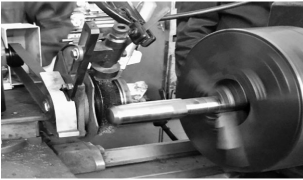
Рисунок 14 — Процесс нанесения покрытия на плунжер Figure 14 — Application process of plunger coating
