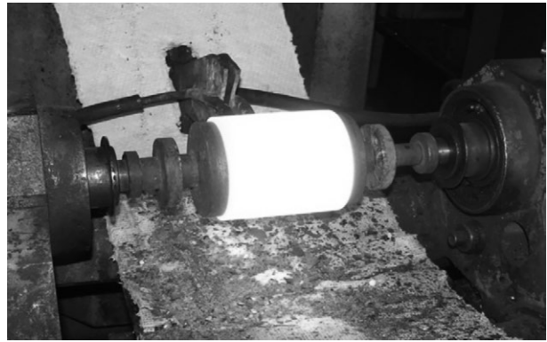
Рисунок 16 — Процесс центробежной индукционной наплавки износостойких антифрикционных покрытий из порошковых шихт с активирующими добавками Figure 16 — Process of centrifugal induction surfacing of wear-resistant antifriction coatings made of powder charge materials with activating additives
