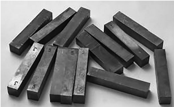
Рисунок 15 — Композиционный материал-донор для формирования теплостойких покрытий Figure 15 — Composite donor material for the formation of heat-resistant coatings
