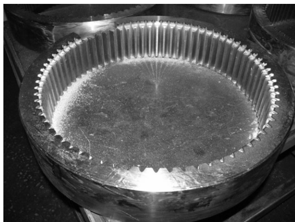
Рисунок 2 — Шестерня из азотируемой стали 40ХМФА Figure 2 — Gear made of nitrided steel 40ХМФА (40KhMFA)
