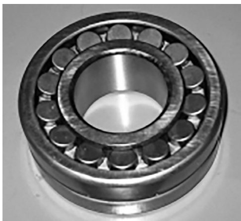
Рисунок 23 — Подшипники качения с кольцами из стали У8А Figure 23 — Rolling bearings with rings made of steel U8A
