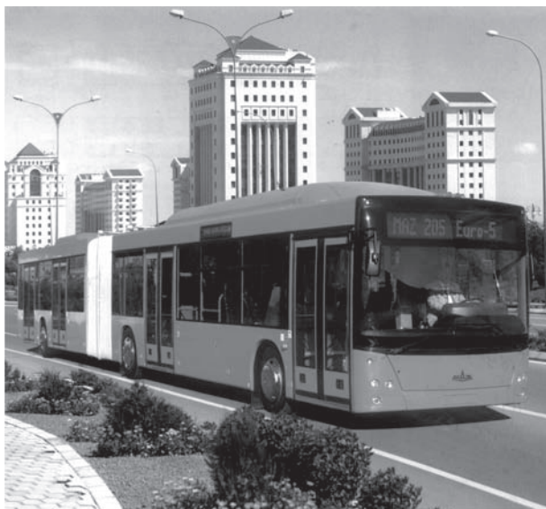
Рисунок 10 — Супернизкопольный сочлененный городской автобус второго поколения MAZ-205
