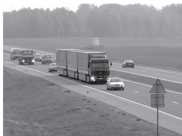
Рисунок 8 — Испытания первого экспериментального образца многозвенного автопоезда: a — полигонные; b — пробеговые в реальных условиях эксплуатации
