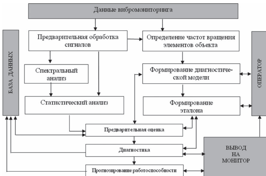
Рисунок 6 — Алгоритм процесса виброакустической диагностики РМК
