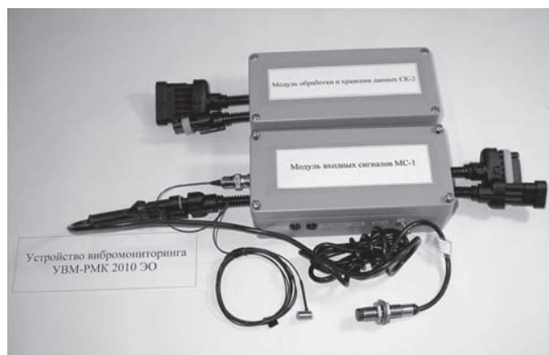
Рисунок 7 — Бортовая система вибромониторинга и диагностики РМК самосвала БелАЗ
