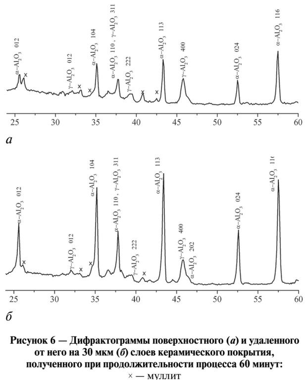
Рисунок 6 — Дифрактограммы поверхностного (а) и удаленного от него на 30 мкм (б) слоев керамического покрытия, полученного при продолжительности процесса 60 минут:
