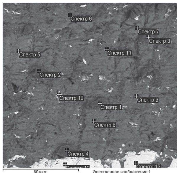
Рисунок 5 — СЭМ-изображение ХГДН-покрытия
